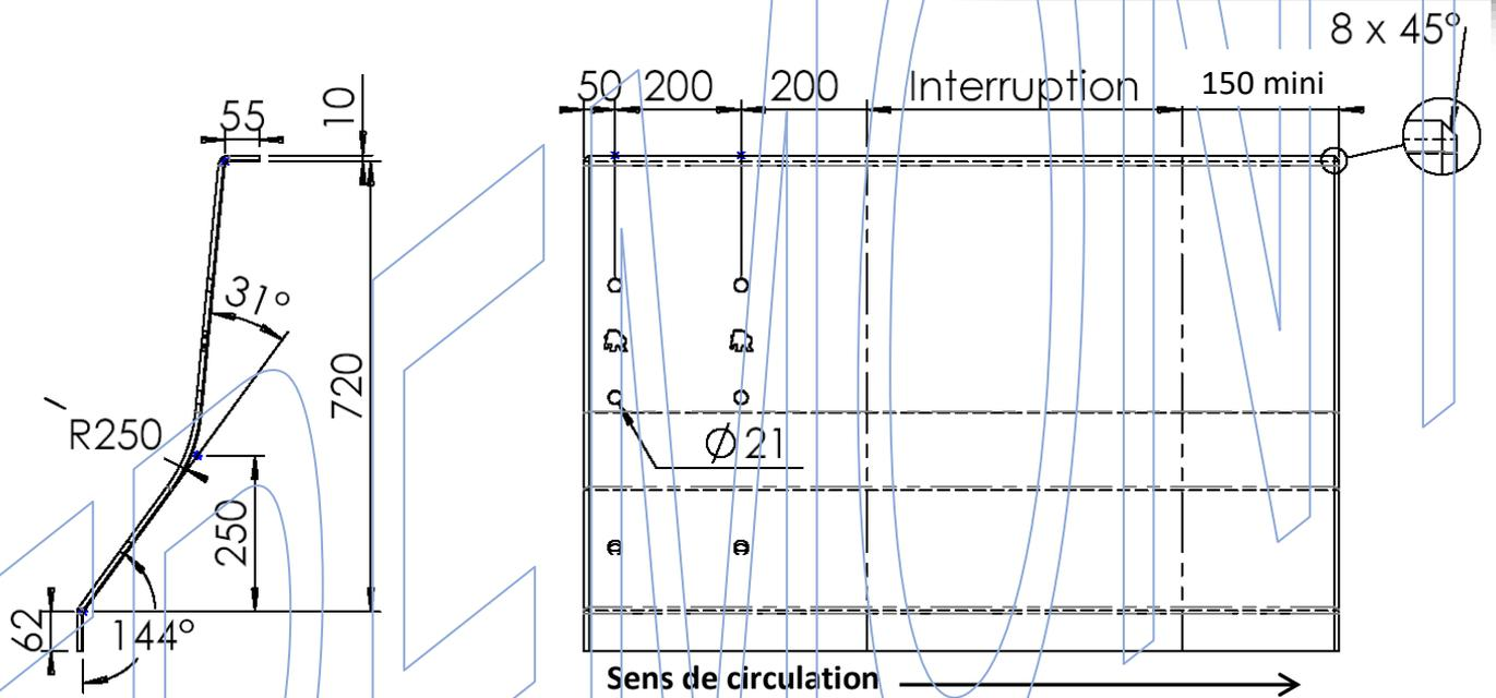
**Attention :** les extrémités d'une interruption de séparateur GBA et DBA ne sont ni N2, ni H1, ni H2. Elles doivent être impérativement renforcées par des armatures FREMONT. L'armature FREMONT a fait l'objet le 27 mai 2019 d'un crash test VINCI/FREMONT destiné à valider le concept des armatures de GBA soit « GBA avec extrémité renforcée ». Toutes nos fournitures posées selon nos notices sont H2.
