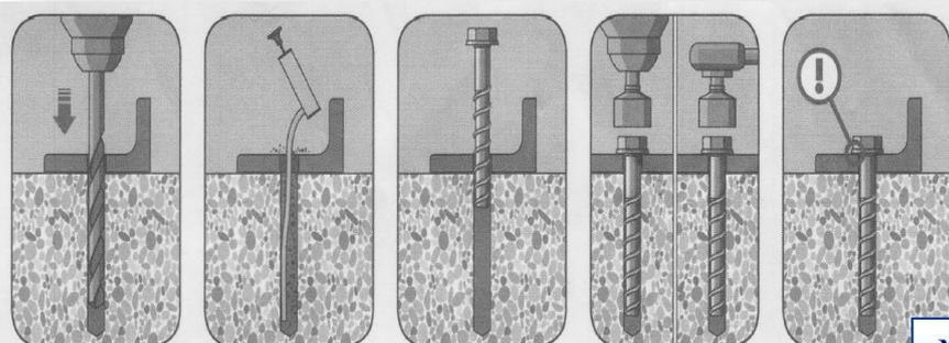
Mise en œuvre des 2 vis d'ancrage 6x60
