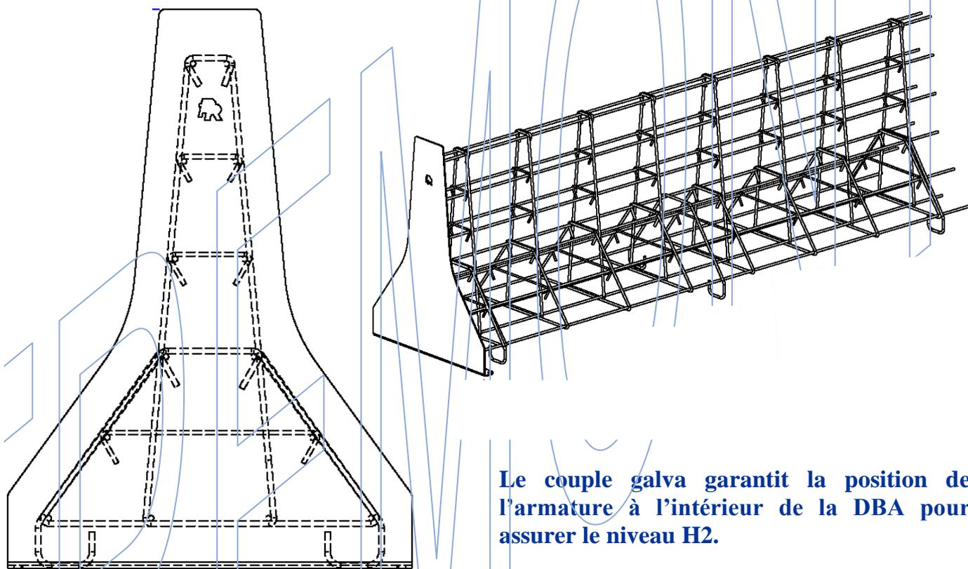
Le couple galva garantit la position de l'armature à l'intérieur de la DBA pour assurer le niveau H2.
